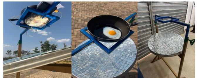
**Figura 1. fogão solar construído**
