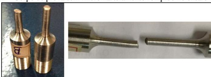
Pode-se observar que o corpo de prova apresentou uma fratura característica de fratura dúctil, que ocorre apenas após deformação plástica extensa e é caracterizada pela lenta propagação de trincas resultantes da nucleação e crescimento de micro cavidades no material.
