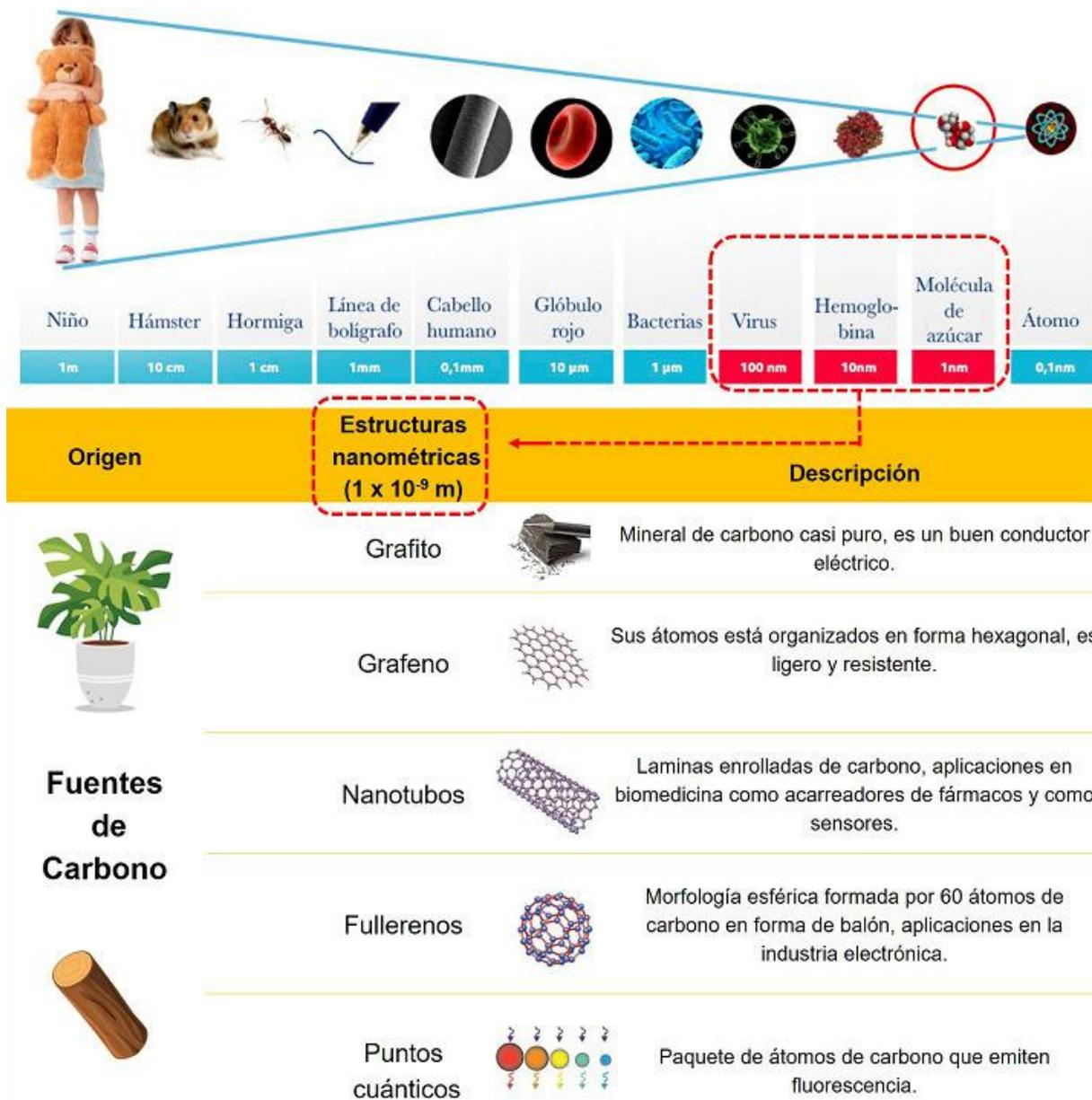
**Figura 1.** Esquema que representa las dimensiones de la escala nanométrica y las estructuras que se pueden obtener a partir de fuentes de carbono. Fuente: escala nanométrica obtenida de <https://adciesparquegoya.wordpress.com/2017/12/09/nanociencia/>. Tabla: autoría propia.
