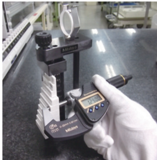
Figura 47 Soporte de bloque patrón para calibración de micrómetros (desarrollado en 2002)
