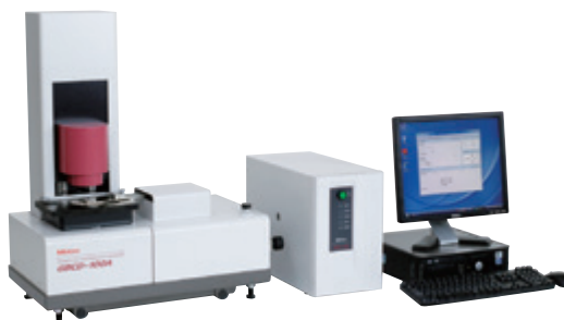
Figura 43 Comparador automático de bloques patrón
