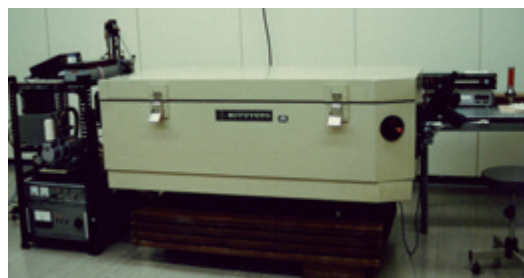
Figura 35 Interferómetro para medir bloques patrón largos
