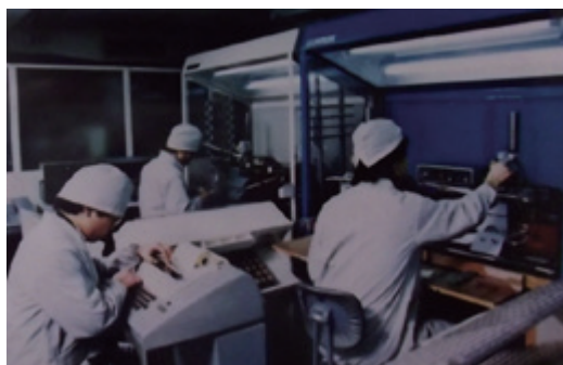
Figura 31 Calibración de bloques patrón con el probador de calibración automático original
