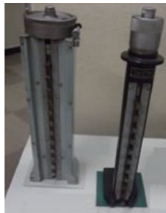
Figura 21 Maestro de altura original (micrómetro de control de altura)
