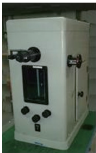
Figura 28 Interferómetro Koester (comparador de interferencias fabricado por Carl Zeiss Jena Corporation en la antigua Alemania del Este)
