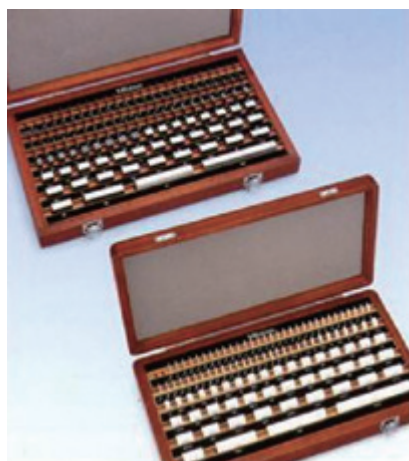
Figura 36 Bloques patrón de acero Mitutoyo (atrás) y bloques patrón de cerámica (frente)
