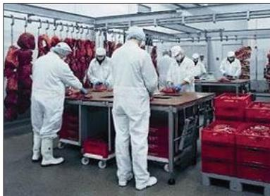
Tiefkühlbeständige Untersetzwagen für den Transport von Euro-Fleischkästen in und aus der Gefrierzelle.
