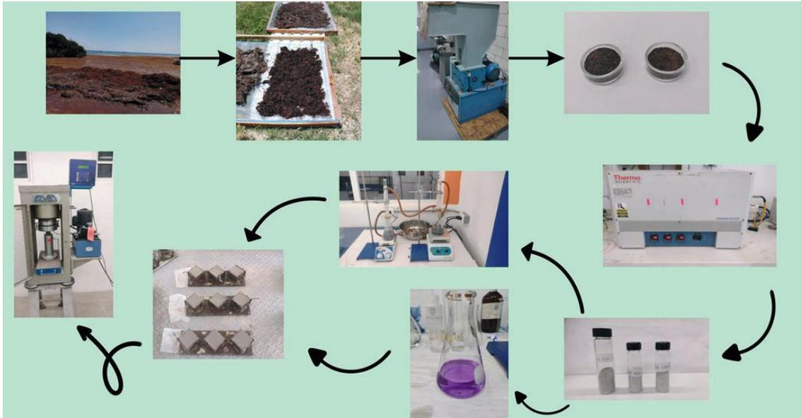
**Figura 3.** Proceso de obtención y utilización de la ceniza de sargazo como sustituto parcial de cemento.
