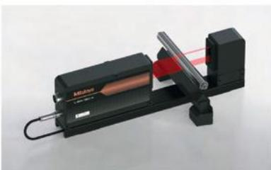
Medición simultánea del diámetro exterior y la desviación del rodillo
