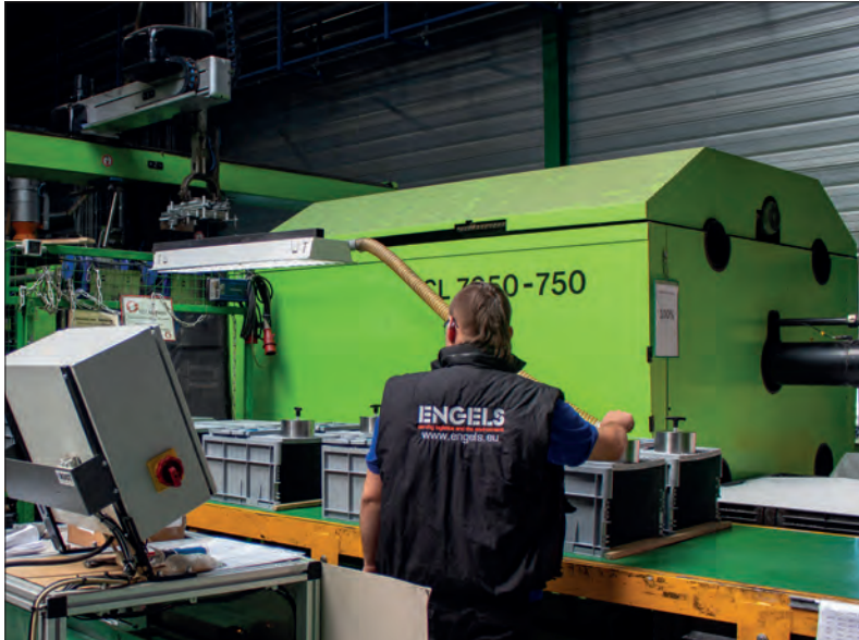
Het spuitgieten van een kunststofbak met uitneembare wand in opdracht van een klant.
