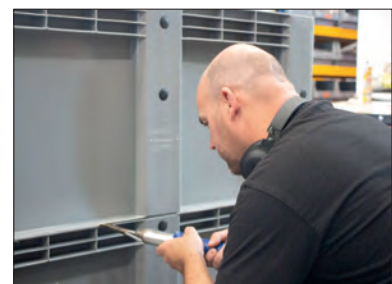
Handlassen van een kunststof palletbox.
