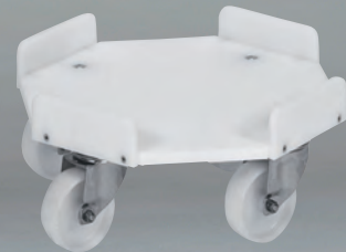
transportroller, achthoekig uit 15 m dik PE met 4 opstaande randen van 70 mm
