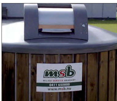
Tièrso met afsluitbare trommel in Vught. Cilinderslot gelijk aan toegang wooncomplex.
