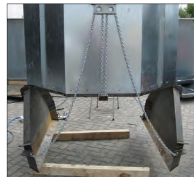
Dubbele bodemklep, welke gecontroleerd geopend kan worden. Aan de binnenzijde van de container met dubbele klep zijn er geen bewegende delen van het bedieningssysteem.
