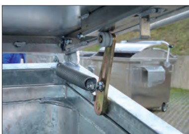
Deksel blijft open staan door veermechanisme.
