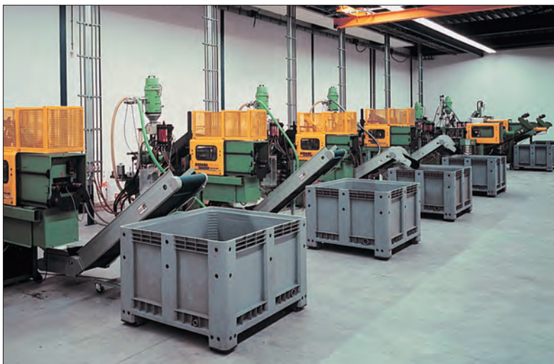
Palletboxen in gebruik in een spuitgietfabriek.
