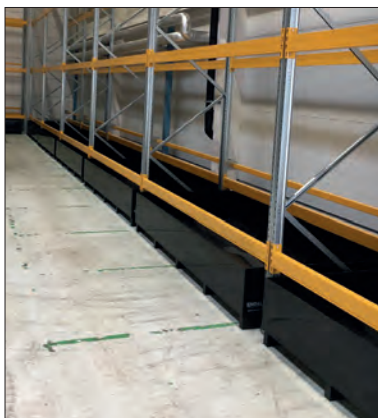
Speciaal ontwikkelde maatwerk lekbak. Geschikt voor het opvangen van ten minste 110% van de inhoud van de IBC (intermediate Bulk Container) die in de stellingen komen te staan.
