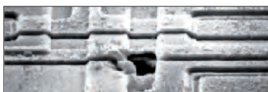
Schade aan een microprocessor door statische ontlading.
