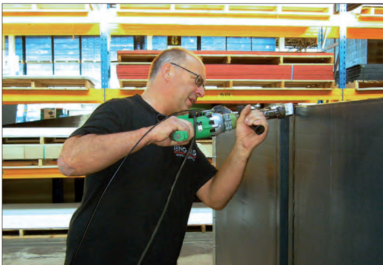
Lassen met een extruder. Kunststof wordt in de naad geëxtrudeerd, de omgeving wordt verhit.
