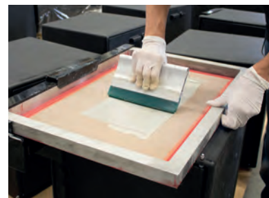
De zeef wordt op de bak gedrukt en in 1 drukkende beweging gaat de inkt op de bak.
