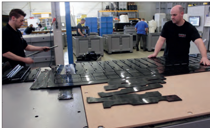
Nadat het materiaal gefreesd is in de machine, worden alle losse onderdelen losgehaald.
