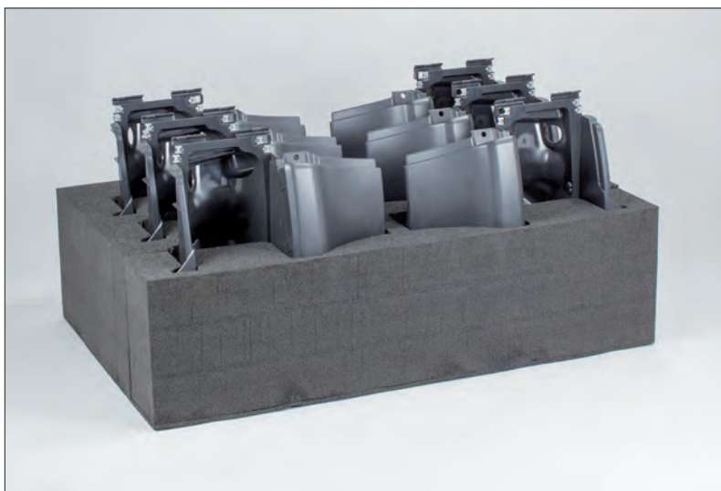
Schuiminterieur voor Scania, passend in een palletbox.
