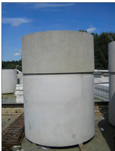
2-delige betonput. Beton-kwaliteit C30/37 XC4, grondwaterbestendig.
