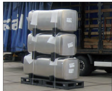
Aan elkaar gelaste pallets voor vervoer van brandstof tanks.
