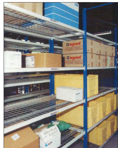
Een stelling met schappen van metaalgaas voor opslag van dozen en kunststof bakken.
