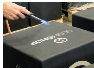
De bakken worden gevlamd zodat de inkt goed aan de bak blijft hechten.
