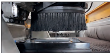
Het CNC frezen van een papiersleuf in de deksel van een 2-wiel container.
