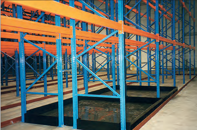
Lekbakken, passend gemaakt voor de rekken in dit palletmagazijn.
