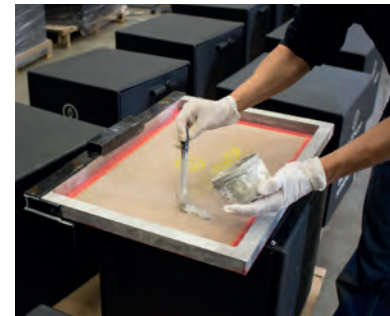
De inkt wordt met een kwast aangebracht op de zeef.
