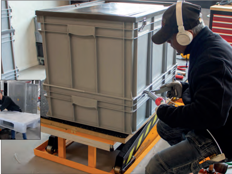
Lassen met een föhn, precies vakwerk. De kunststof draad wordt in de las gesmolten.
