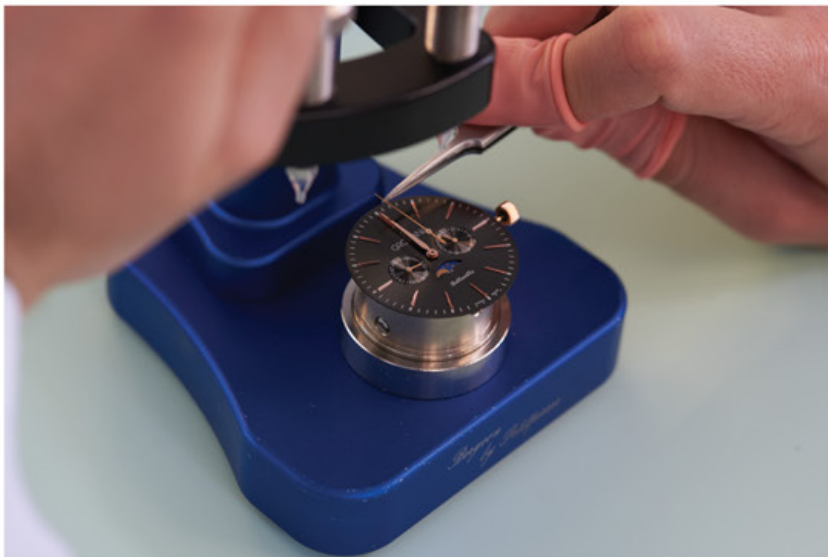
setting of hands Zeiger setzen posage d'aiguilles montaje de agujas
