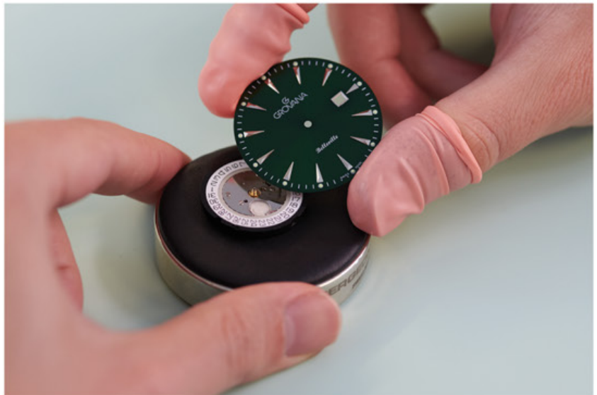
setting of dial Zifferblatt setzen posage de cadran montaje de esfera
