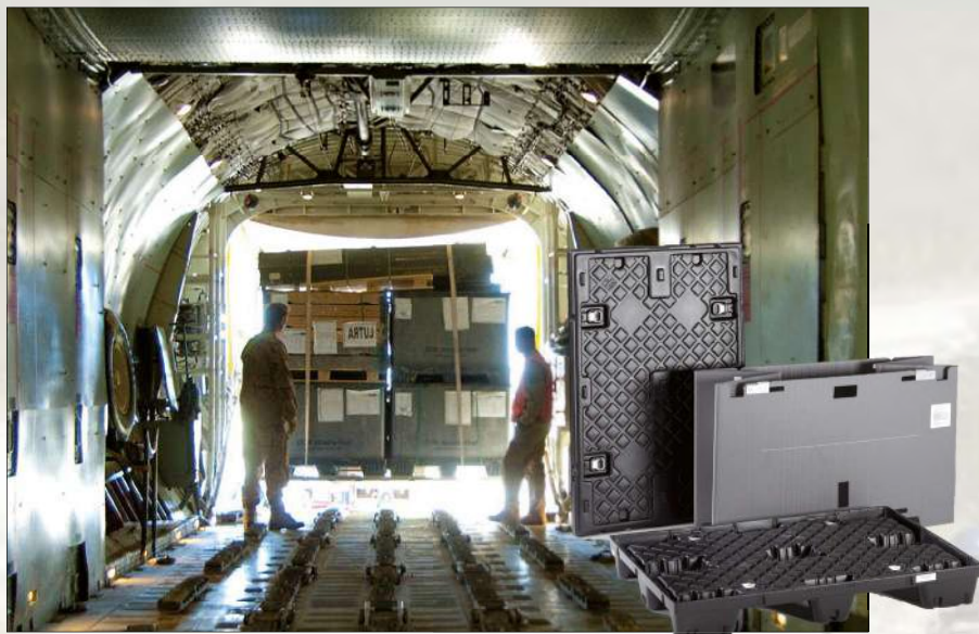
Les palettes et couvercles Lightpak™ sont expédiés empilés à vide, tandis que les rehausses pliées s'emboîtent efficacement sur une palette munie d'un cadre. Cela permet une réduction de 85 % du volume lors du transport retour.
