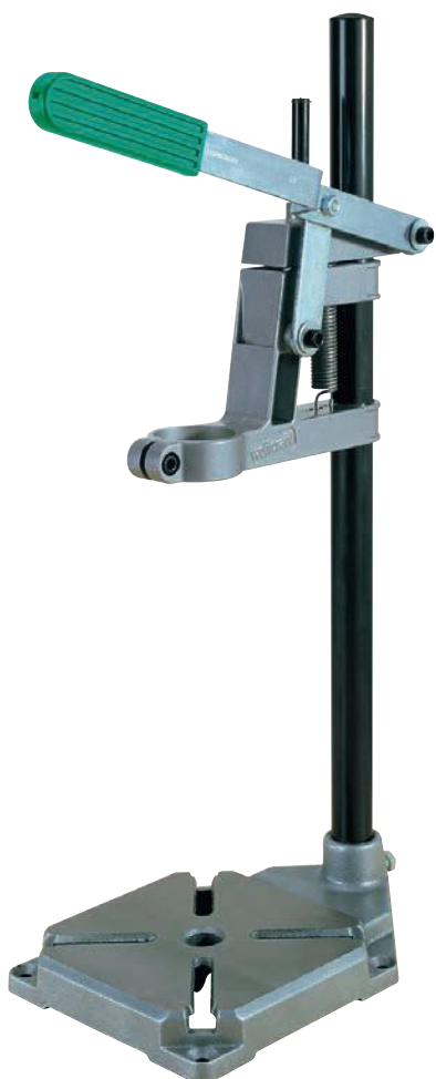
344308 3406000. Universal, válido para la mayoría de taladros del mercado. Altura de trabajo 345 mm. Placa de fundición gris 160x160 mm. Tope de profundidad. Muelle de recuperación.
