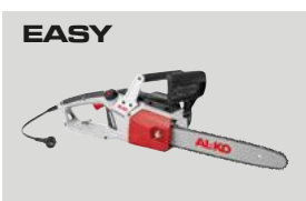
EASY EKS 2000/35 2000 W / 230 V / 50 Hz Silnik Crossline Łańcuch 3/8" Prędkość łańcucha 13,5 m/s Smarowanie automatyczne Waga 4,8 kg Nr Artykułu: 112807
