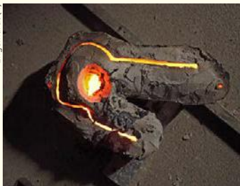
Glühend noch steht die abgegossene Form da und muss nun über Stunden erkalten
