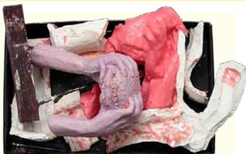
Aufwändig: Mutterform (lila), Silikon (pink) und schließlich die Einzelteile (weiß) der späteren Gußform
