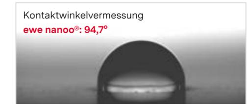
Der **Kontaktwinkeltest nach EN ISO 11998** hat es bestätigt: ewe nanoo® weist im Vergleich zu anderen Oberflächen einen **enorm starken Abperleffekt** auf. Beim Testverfahren erzielte die Oberfläche **hervorragende 94,7°**.
