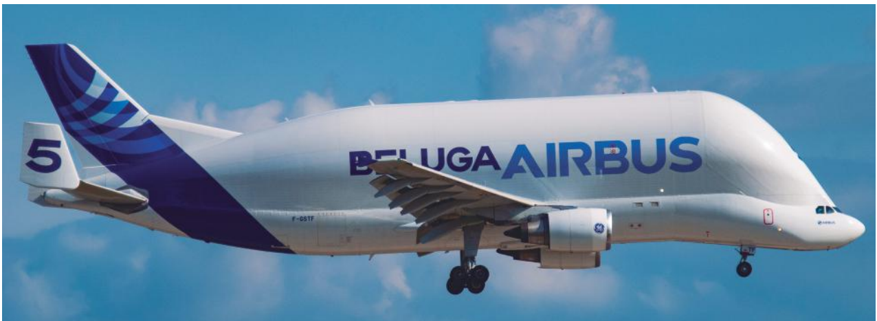
Beluga substitui os antigos "Super Guppy" no transporte de componentes e partes de aeronaves entre as fábricas da Airbus
