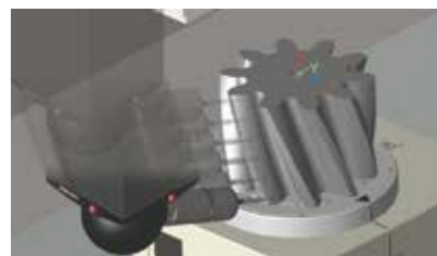
Ejemplo de medición con palpador para instrumentos de medición de contornos. Las raíces estrechas se pueden medir.
