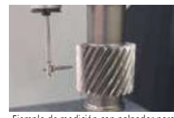
Ejemplo de medición con palpador para instrumentos de medición de contornos. Las raíces estrechas se pueden medir.
