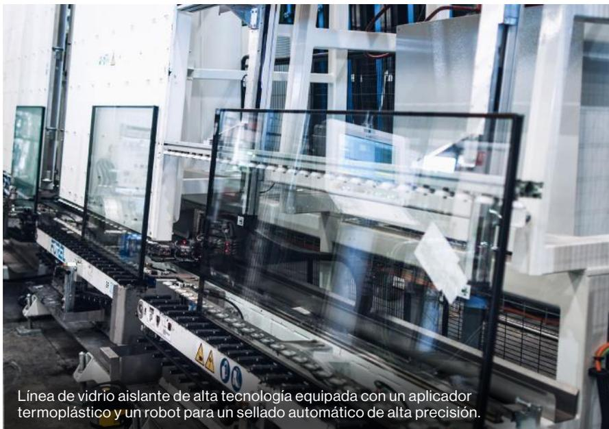
Línea de vidrio aislante de alta tecnología equipada con un aplicador termoplástico y un robot para un sellado automático de alta precisión.
