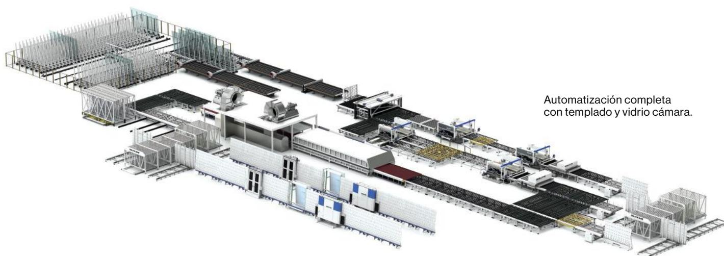
Automatización completa con templado y vidrio cámara.
