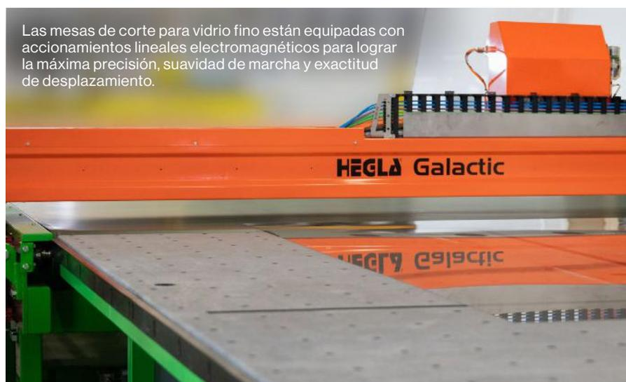
Las mesas de corte para vidrio fino están equipadas con accionamientos lineales electromagnéticos para lograr la máxima precisión, suavidad de marcha y exactitud de desplazamiento.
