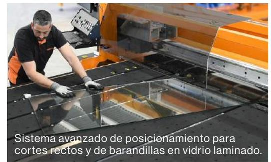
La primera herramienta está diseñada específicamente para cortes de vidrio de 0,55 mm hasta 2 mm, una capacidad que TUROMAS ofrece desde hace más de 15 años y que marca una diferencia clave en el mercado. TUROMAS lleva desde 2008 garantizando un corte fiable, preciso y sin defectos en espesores mínimos de
