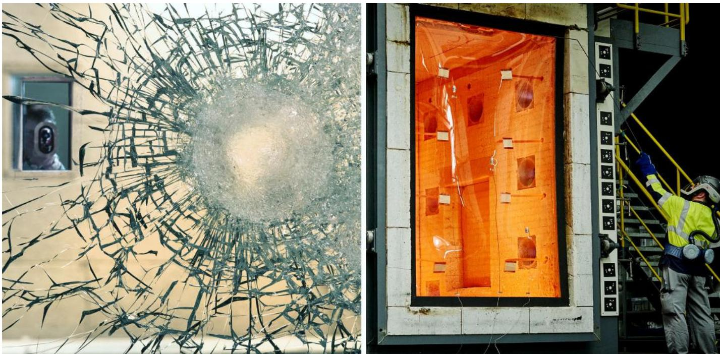
VETROTECH dispone de laboratorios internos para ensayos de resistencia al fuego y pruebas balísticas, donde se evalúan soluciones completas de vidrio y marco para apoyar a los clientes desde las primeras fases del desarrollo.
