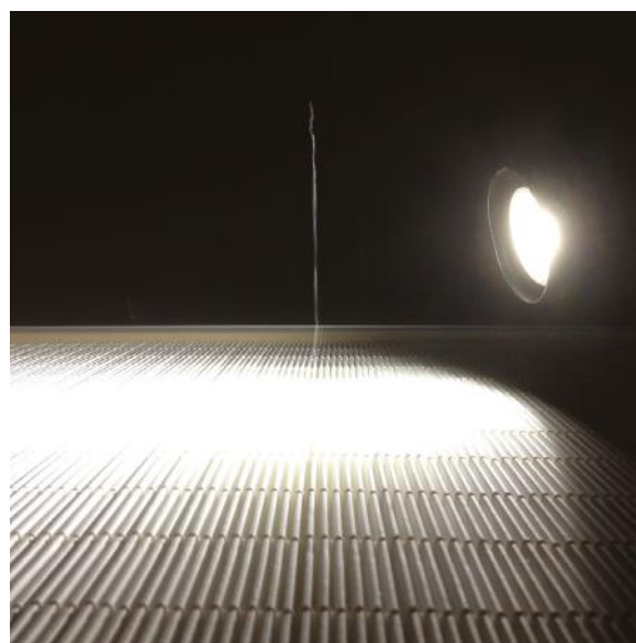
Photo : Filet de fumée - test de micro-fuite - EN1822-4 (Annex A)
