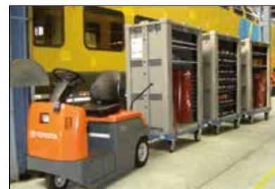
Ausführung mit Zugangssystem. Im Einsatz bei NedTrain für den Service für Personenzüge. Durch den Kunststoff kann der Inhalt mit RFID-Lesern gescannt werden.
