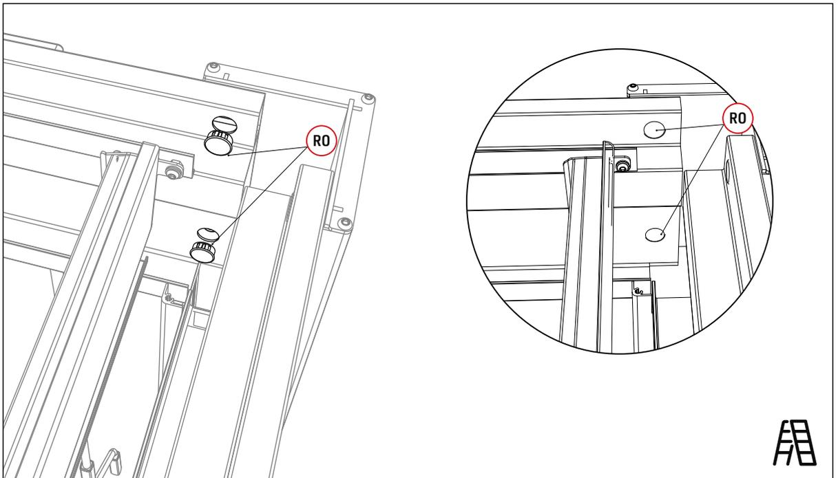
Nach Überprüfung der Maße die Dehnschrauben auf der Platte befestigen.
