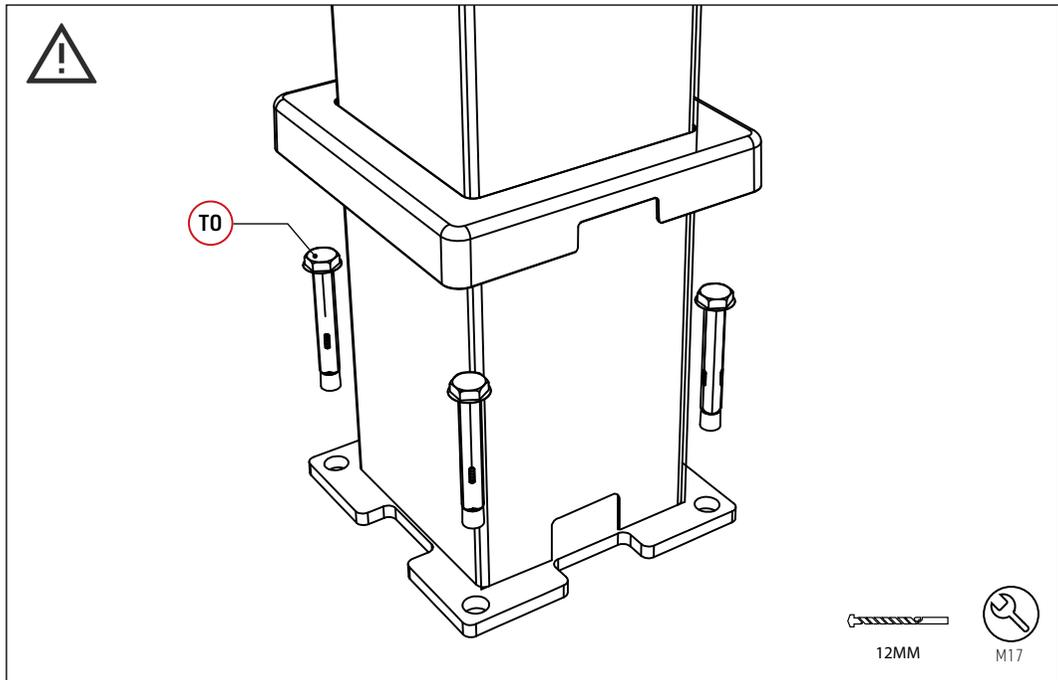
Bewegen Sie die Unterseiten der Pfosten entsprechend den Maßen auf der Titelseite, um sicherzustellen, dass die Abstände gleich sind. Verwenden Sie dann einen 12-mm-Schlagbohrer, um die Löcher vorzubohren. Setzen Sie anschließend die Dehnschrauben ein und ziehen Sie diese mit einem M17-Schlüssel fest.
