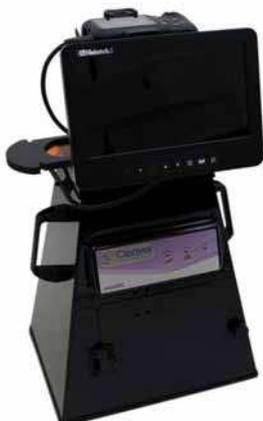
Transfert de données vers l'ordinateur possible avec le logiciel TotalLab™ 1D en option. Utilisation en combinaison avec tout transilluminateur UV 21 x 21 cm. Enregistrement des données sur la carte mémoire possible en RAW, TIFF-RGB et JPEG.
