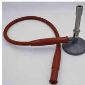
Tuyau de raccordement mobile composé d'un flexible en caoutchouc doté d'une armature métallique intégrée en forme de spirale, et de manchons aux deux extrémités, conforme à DVGW 5501 (P). Résistant à la torsion. Pour la connexion de raccords de gaz de sécurité selon DIN 3383-4 et de brûleurs à gaz pour laboratoires selon DIN 30665 part. 1.
