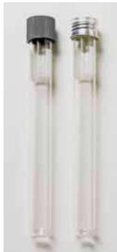
Paroi épaisse (1,1 mm). A col large, facile à inoculer et à nettoyer. Complet avec bouchon à vis en aluminium (autoclavable/stérilisable) ou en plastique (autoclavable à la vapeur à 121 °C/stérilisable) et joint en caoutchouc.
