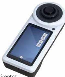
Le photomètre avec 18 longueurs d'onde différentes (3 capteurs avec 6 longueurs d'onde chacun) couvre l'ensemble du spectre visible, ainsi que des parties importantes du spectre UV et IR.
