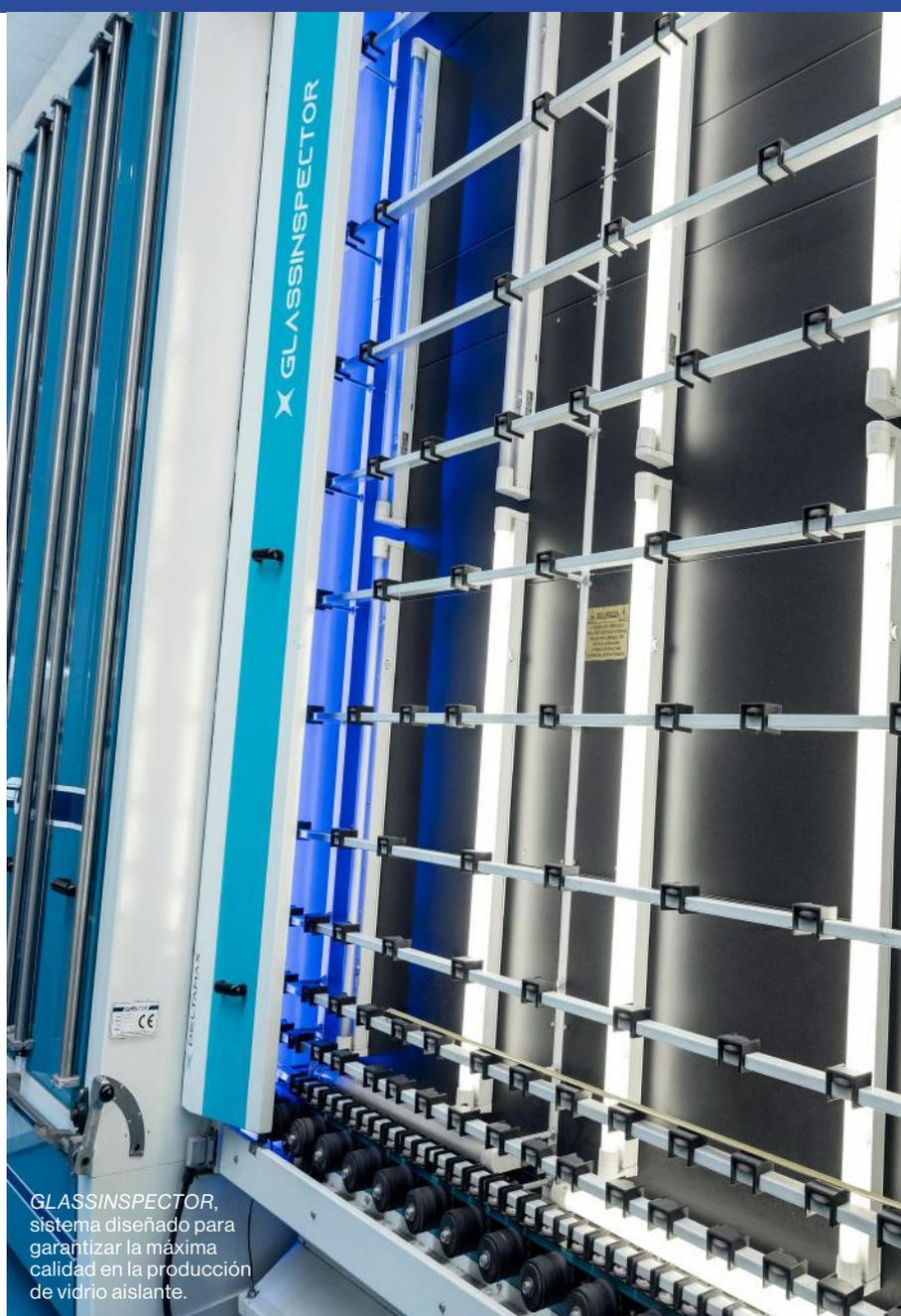
*GLASSINSPECTOR*, sistema diseñado para garantizar la máxima calidad en la producción de vidrio aislante.
