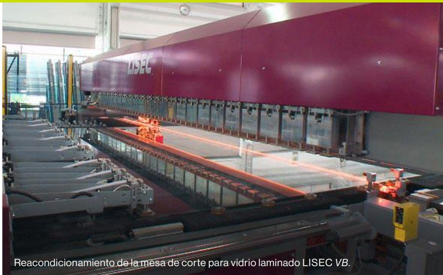
Reacondicionamiento de la mesa de corte para vidrio laminado LISEC VB.
