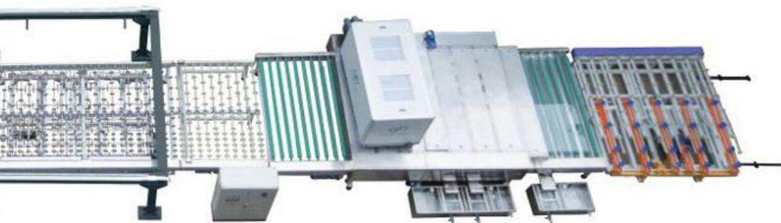
La línea de producción de vidrio laminado es altamente adaptable y precisa, capaz de procesar grandes formatos con películas PVB o SGP, y equipada con tecnología avanzada que garantiza una laminación exacta.
