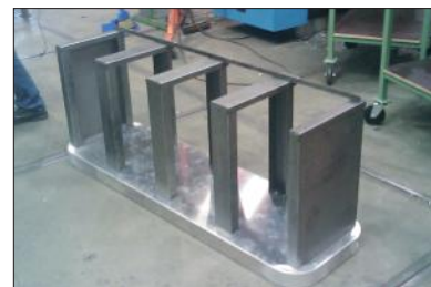
Vorbereitung für die Pulverbeschichtung.
