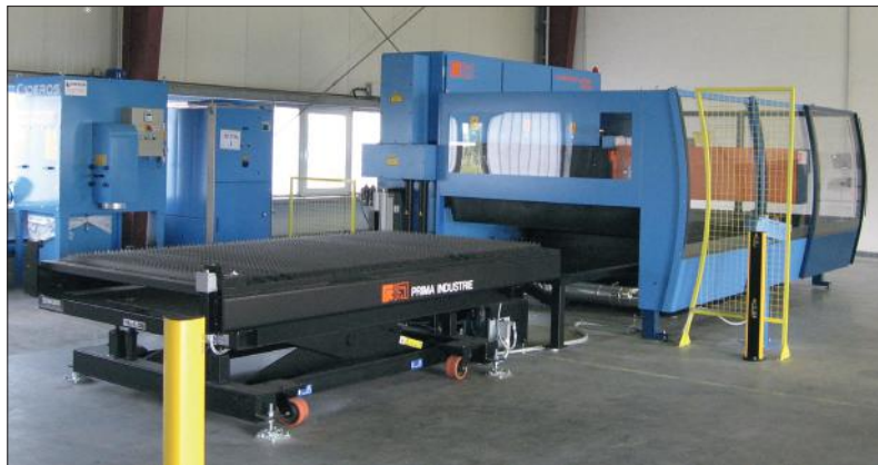
Herzstück unserer Produktion ist die 4000-Watt-Laserschneidanlage.
