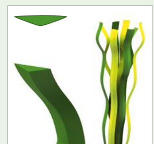
Épaisseur de fibre : env. 255 µm
