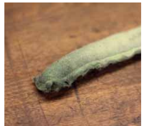
Зношений вставний мішок осушувача - розмокання вологопоглинач через надмірну кількість УФ-засобу, доданого в систему.
