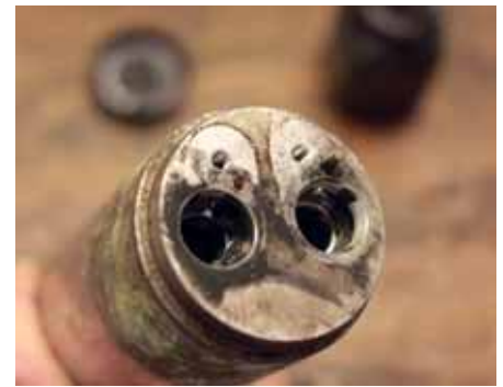
Забруднення вхідних і вихідних отворів призведе до засмічення осушувача.
