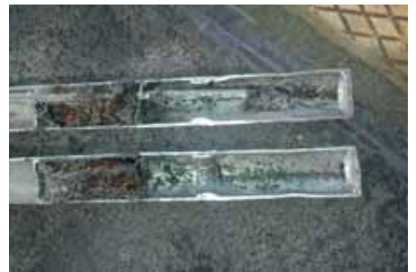
Зношені шари осушувача та фільтра всередині осушувача.
