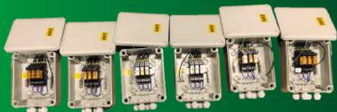
Fan-coil, bővítő relék (150x190x77mm)
