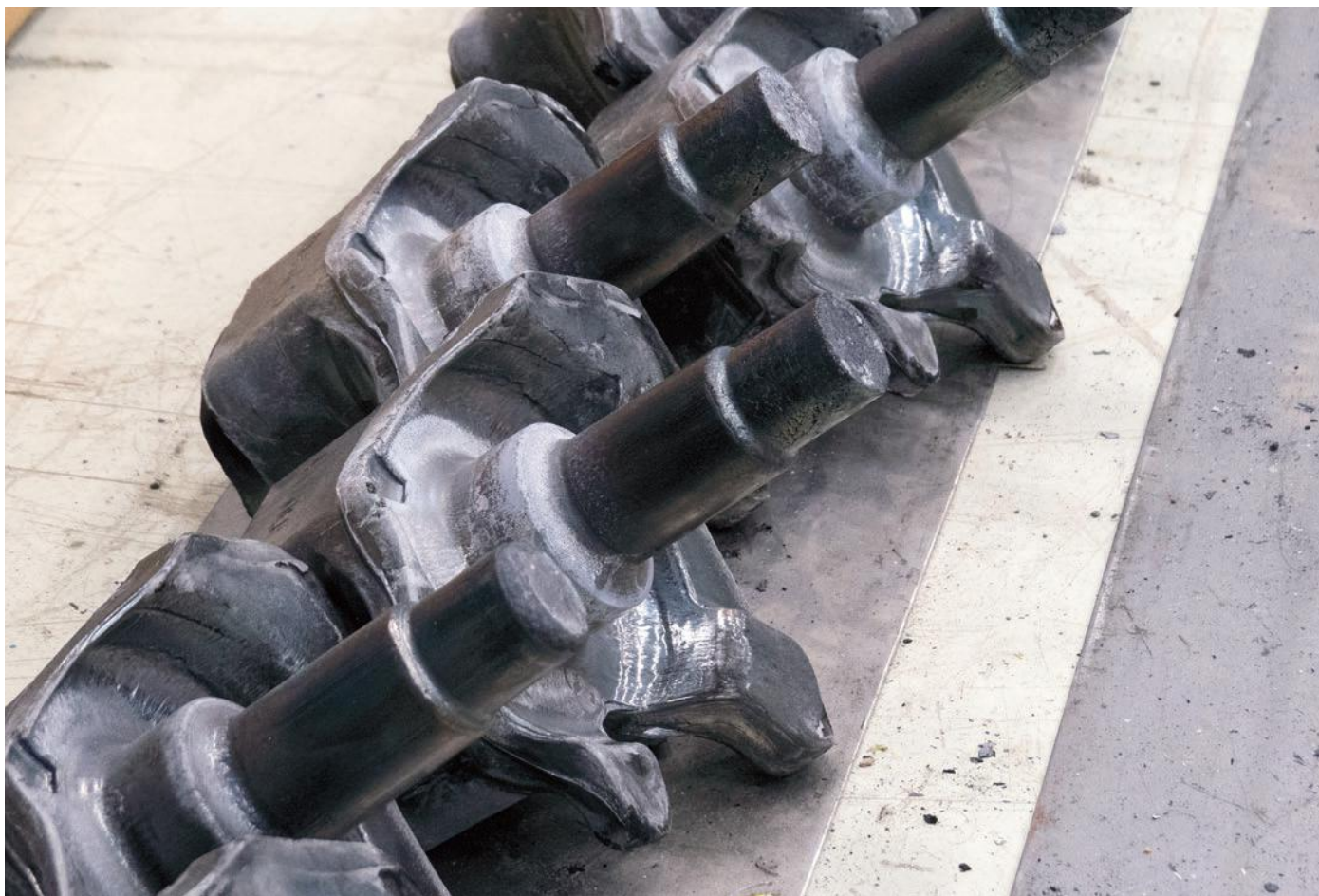
CIE Legazpian tixokonformazio bidez ekoizten ari diren autoetarako piezak. Pieza kritikoa da, eta geometria konplexua du. ARG.: BEÑARDO KORTABARRIA/ELHUYAR ZIENTZIA.
