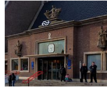
Gerenoeverde gevel entreehal met nieuwe toegangsdeuren, luifel en klok naar de oorspronkelijke vormgeving van Van Ravesteyn, dec. 2013
