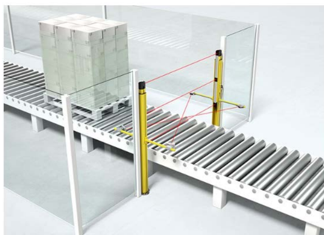
Muting de 2 sensores con control temporizado
