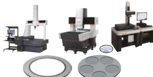
Piezas para equipos CVD: Cabezal de inyector, Diámetro interior del orificio del inyector, Redondez, Posición, Análisis de textura superficial (Rugosidad 3D)
