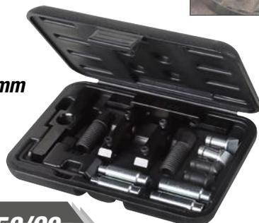
Surtido de herramientas para extraer e insertar: silentblocks del eje trasero, retenes de aceite del cigüeñal y cojinetes de rueda
