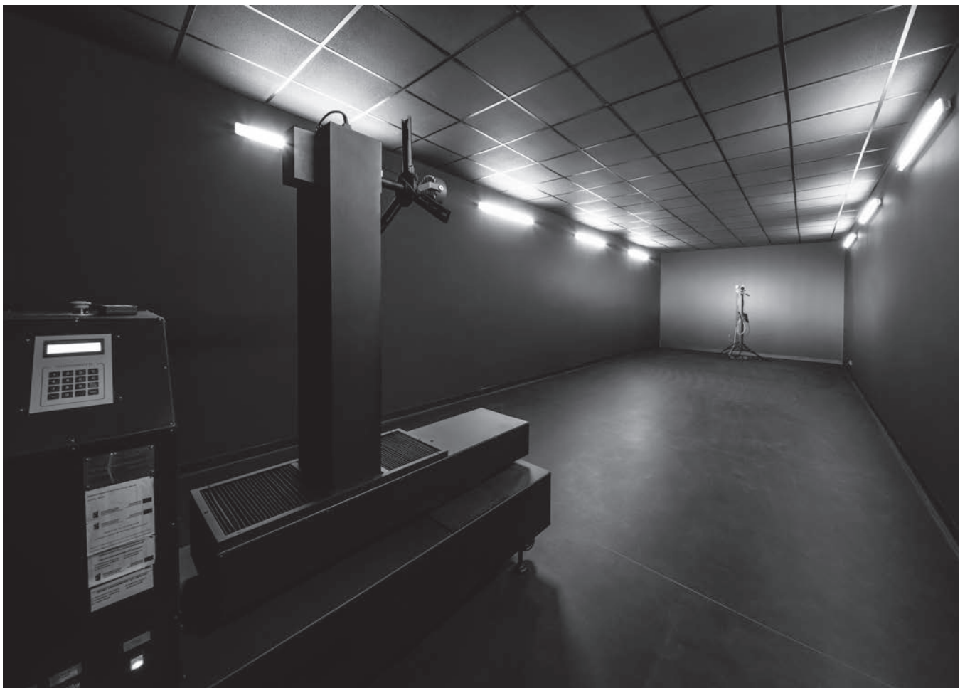
Photogoniometer in Liralighting photometric laboratory Fotogoniometr w laboratorium fotometrycznym Liralighting
