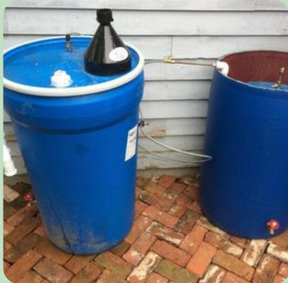
Gambar 4.3 Biogas Sederhana
