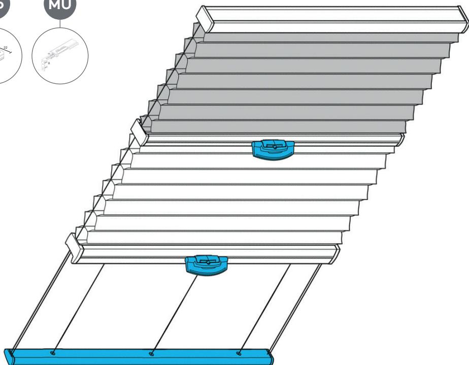
Spannseile feststehend, Abstand ca. 20 cm. Bei Schrägmontage Paket nach Möglichkeit oben anordnen.
