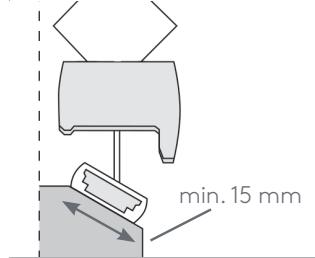
Schnitt Glasleiste mit Spannschuh und Unterschiene
