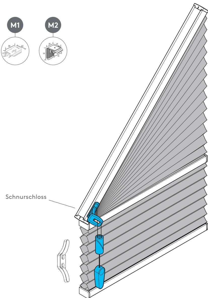
Der Behang ist bis in die Schräge hochziehbar.
