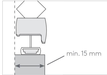
Schnitt Glasleiste mit Spannschuh
