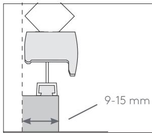
Schnitt Glasleiste mit Spann-
