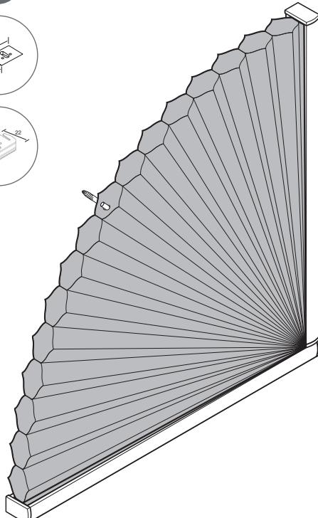
**Duette**, komplette feststehende Viertelkreis-Anlage, **lässt sich nicht bedienen**. Zur Reinigung kann das Duette leicht ausgeklickt werden. Falls es sich nicht um einen exakten Viertelkreis handelt, bitten wir um Beistellung einer Schablone.
