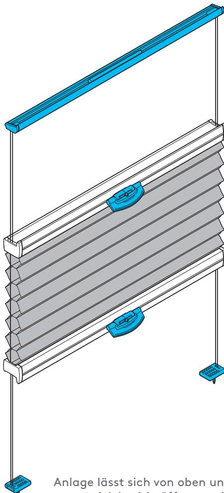
Anlage lässt sich von oben und unten gleichzeitig öffnen und schließen. Anlage lässt sich auch kopfüber montieren.
