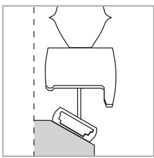
Angepasste Unterschiene für schräge
