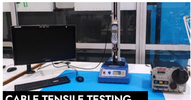
CABLE TENSILE TESTING MACHINES (PULL TEST)
