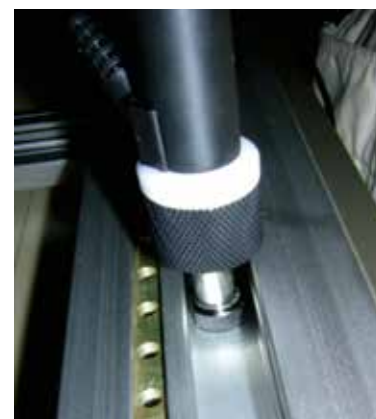
• Ensayos de dureza en huecos y ranuras y con superficies ligeramente irregulares
