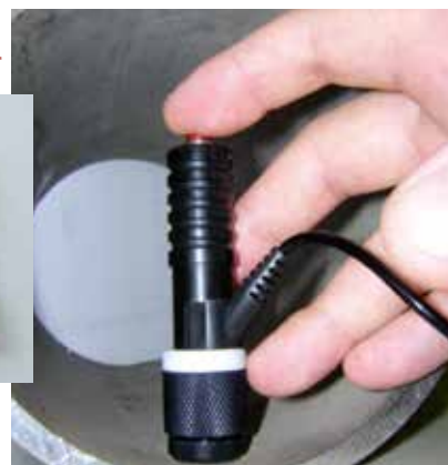
• Ensayos de dureza de paredes internas de tuberías y espacios reducidos
