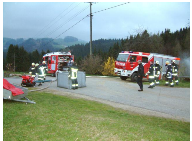
Falttank - für rasche Wasserversorgung
