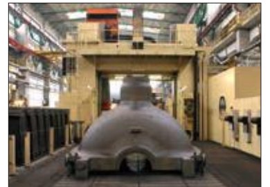
Portalfräsmaschine zur Bearbeitung von Gussteilen
