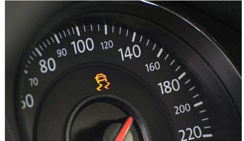
El **Control de Estabilidad Electrónico (ESP)** es tu aliado en la carretera. Detecta el deslizamiento o el desvío inesperado y ajusta la potencia de frenado y la distribución de la fuerza motriz para mantener el vehículo en la trayectoria correcta.
