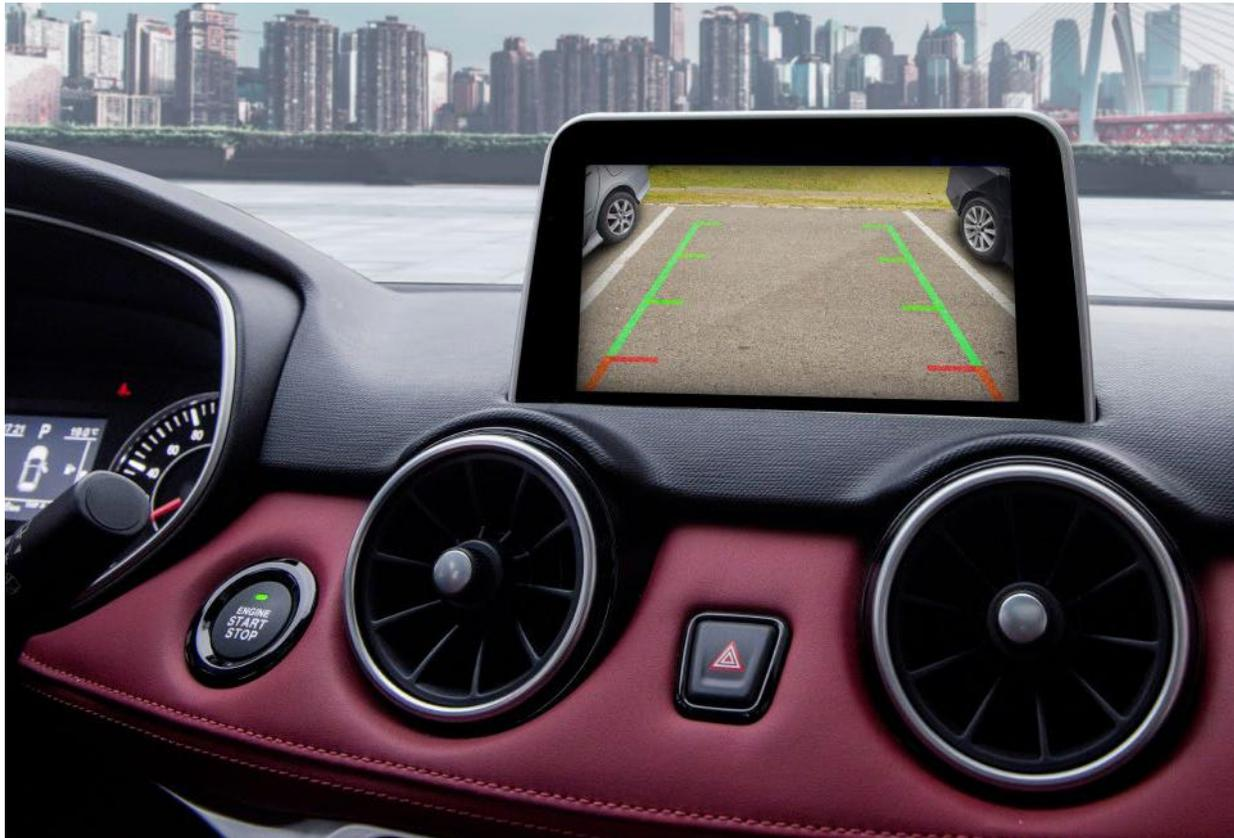
La **cámara de visión trasera HD** es tu aliada en la maniobra y la seguridad. Con su visión clara y amplia de la parte trasera del vehículo, te permite estacionar y moverte con confianza en espacios reducidos.
