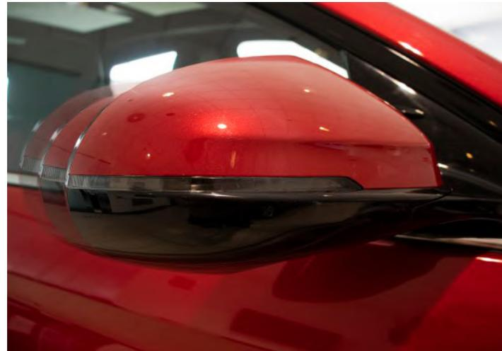
Los **retrovisores ajustables y plegables eléctricamente** ofrecen la máxima comodidad al conductor, permitiendo una personalización rápida y precisa para una conducción más segura.
