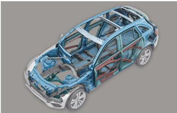
La carrocería del 500 incorpora un avanzado **sistema de deformación programada**, diseñado con meticulosidad para garantizar que en caso de una colisión, el habitáculo del conductor y los pasajeros permanezcan en un refugio seguro e inalterado.
