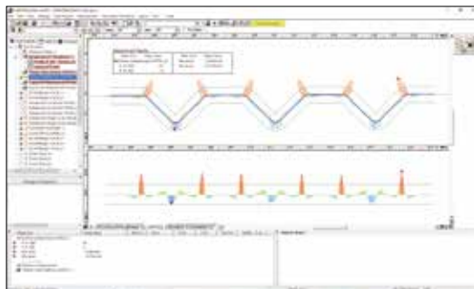
Ejemplo de resultado de tolerancia de contorno en forma gráfica
