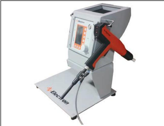
Das E-LAB DI Pulverbeschichtungssystem ist ideal für Labortests mit kleinen Proben. Es saugt Farbe durch einen Probebeutel an und bietet Flexibilität mit allen elektrischen und pneumatischen Funktionen des E-COAT-Mastermodells sowie einem abnehmbaren Sockel für die Pulverpistole (E-GUN C1).
