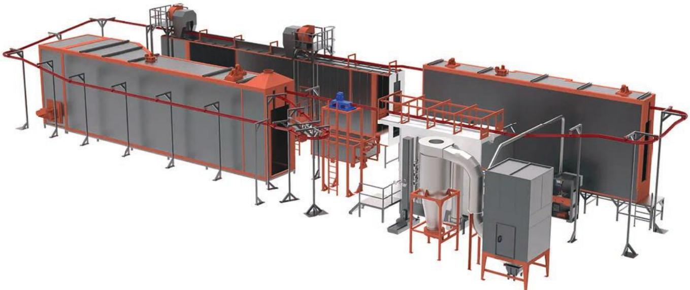
Trocken- und Härtnungsöfen spielen eine entscheidende Rolle im Beschichtungsprozess, indem sie das auf den bearbeiteten Teilen aufgetragene Pulver oder Beschichtungsmaterial bei der gewünschten Temperatur und für die erforderliche Zeit trocknen oder aushärten. Dieser entscheidende Schritt beeinflusst maßgeblich die Haltbarkeit, Haftung und Oberflächenqualität der Beschichtung und trägt somit wesentlich zur Gesamtqualität des Endprodukts bei.
