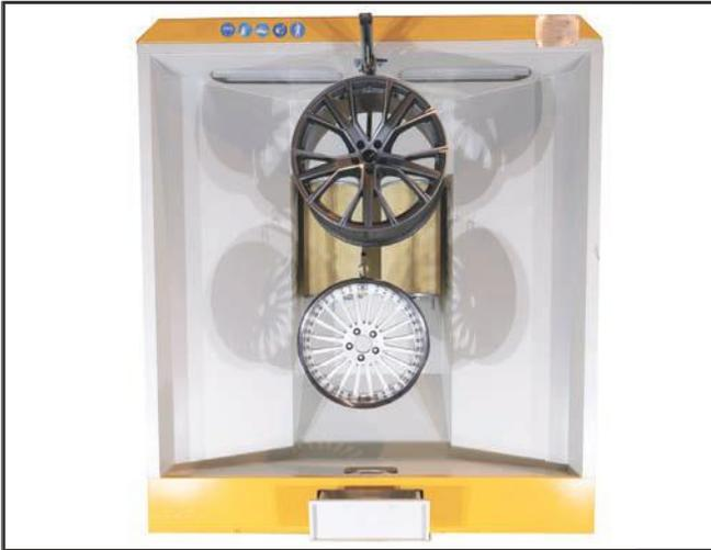
Unsere Pulverabsauganlagen sind unverzichtbar für die effektive Entfernung von übersprühtem Pulver während des Pulverbeschichtungsprozesses. Sie finden Anwendung in verschiedenen Branchen wie Automobil-, Metall-, Glas-, Kunststoffindustrie.
