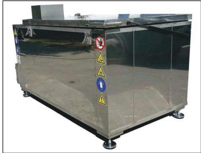
Entlackungsbecken mit Rührwerk aus Edelstahl: Qualität, Leistung, Zuverlässigkeit
