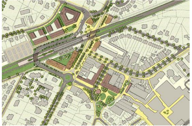
Bij Station Bilthoven wordt autoverkeer en ander verkeer verdeeld over twee onderdoorgangen.
