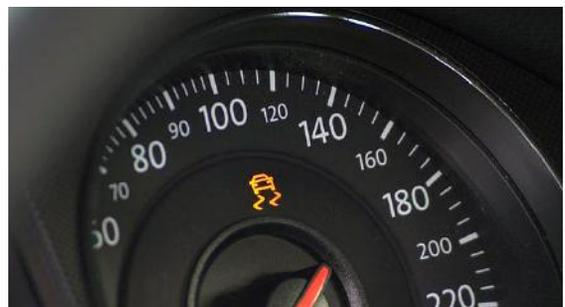
**Control de Estabilidad Electrónico (ESP).** Detecta deslizamientos o desvíos y ajusta la potencia de frenado y la distribución de la fuerza motriz para mantenerlo la trayectoria correcta.
