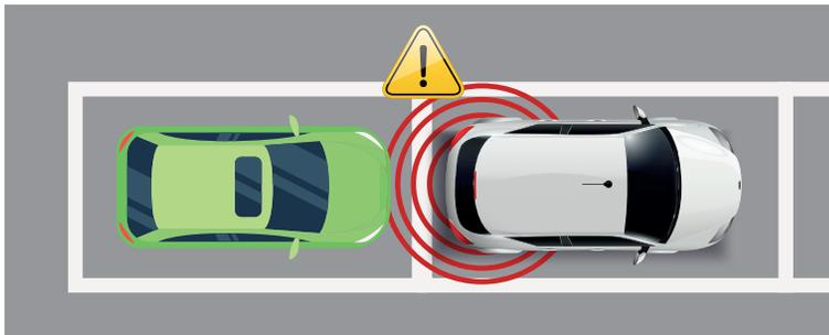
**Sensor de parking trasero.** Detecta la presencia de obstáculos y alertar al conductor con señales sonoras. Esto permite maniobrar el vehículo con mayor precisión.
