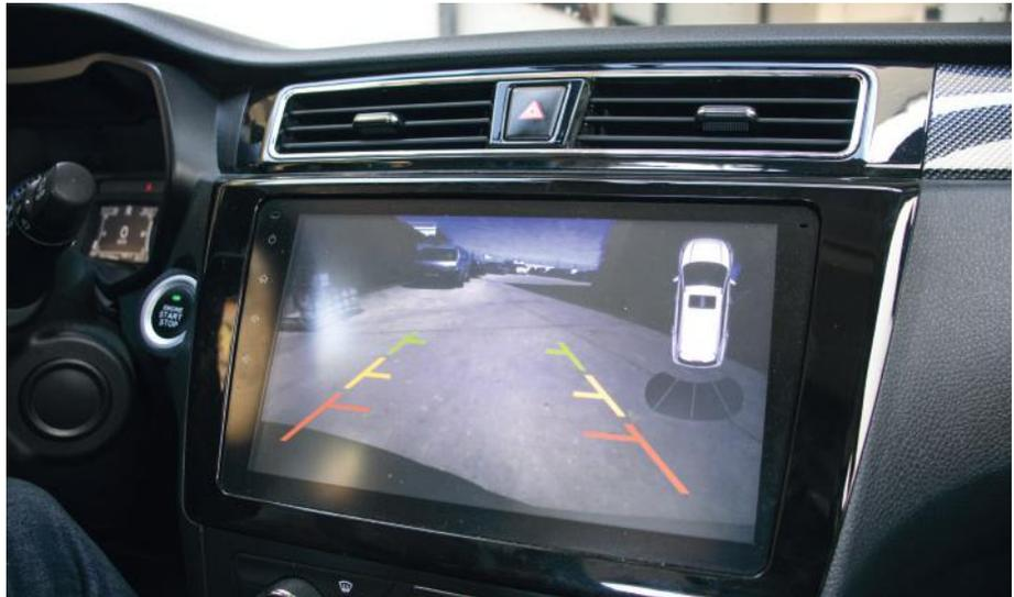
**Cámara de visión 360°.** Proporciona una vista completa del entorno alrededor del vehículo. Esta función mejora la seguridad al estacionar y facilita las maniobras en espacios reducidos
