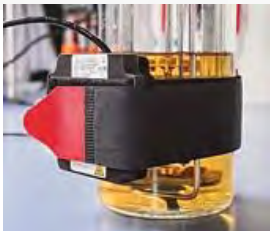
Figura 1. Sensor de biomasa para fermentadores "CGQ BioR".
