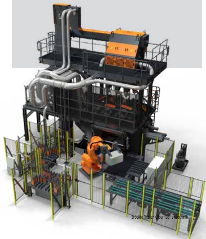
Maszyna do śrutowania bloków silnikowych RMBS umożliwia w pełni automatyczne usuwanie piasku i czyszczenie jednego dużego lub kilku mniejszych bloków silnikowych w bardzo krótkim czasie cyklu.
