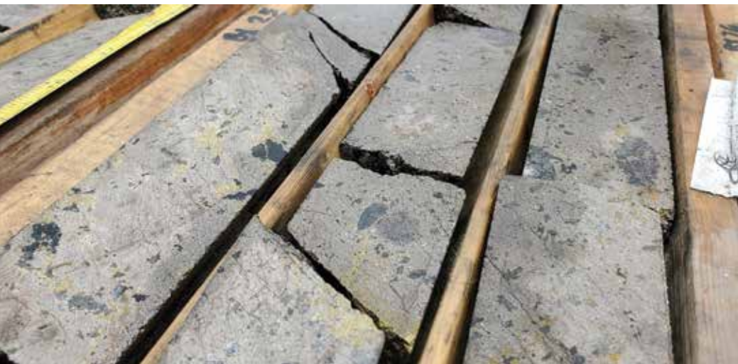
BDF drill core, HPM-08-004, observable pyrrhotite (iron sulphide), chalcopyrite (copper sulphide) and pentlandite (nickel sulphide) intersected 1.64 per cent Ni, 0.63 per cent Cu and 0.08 per cent Co, from 47.73 metres to 63.68 metres. / La carotte de forage de la zone BDF, HPM-08-004, qui contient de la pyrrhotite (sulfure de fer), de la chalcopyrite (sulfure de cuivre) et de la pentlandite (sulfure de nickel) a recoupé 1,64 % de Ni, 0,63 % de Cu et 0,08 % de Co, sur une distance allant de 47,73 m à 63,68 m.
