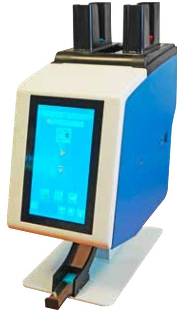
Dank ihrer geringen Stellfläche und ihres geräuscharmen Betriebs können die Drucker auf dem Schneidetisch neben dem Mikrotom aufgestellt werden. Dadurch wird der Prozess des Scannens von Patientengewebeblöcken, des Schneidens und des Aufziehens direkt auf den präzise bedruckten Objektträger rationalisiert.
