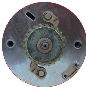
Dubbele rempal met RVS veren
