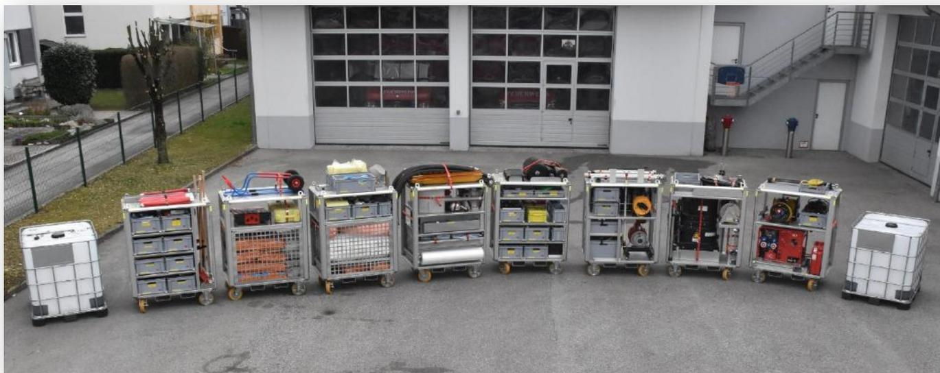
Rollcontainer mit div. Gerätschaften zum Auffangen, Abdichten und umpumpen bei Unfällen mit Mineralölen, Säuren, Laugen und gefährlichen Stoffen auf der Straße, Schiene, im Schiffsverkehr und in Betrieben.
