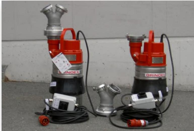
Schwere Schmutzwasser-Tauchpumpen, geeignet für jegliche Art von Einsätzen. Ausgestattet mit einer Motorschutzeinrichtung, elektronischen Drehrichtungsschutz sowie Thermo-fühlern, und Trockenlaufsicher
