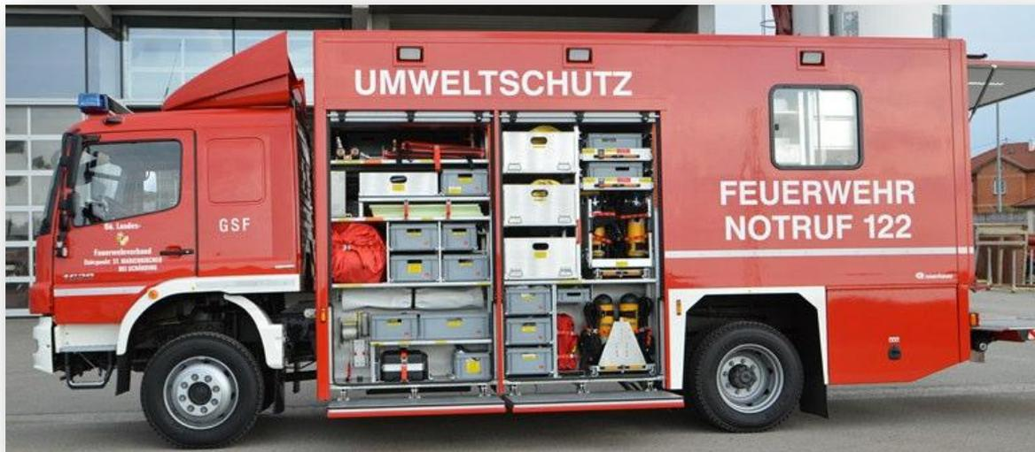
Fahrzeug mit Gerätschaften zum Auffangen, Abdichten und Umpumpen bei Unfällen mit Gefährlichen Stoffen auf der Straße, Schiene, Schiffsverkehr und in Betrieben. Außerdem ausgestattet mit zahlreichen Geräten und Unterlagen zum Aufspüren, Erkennen und Identifizieren von Gefährlichen Stoffen
