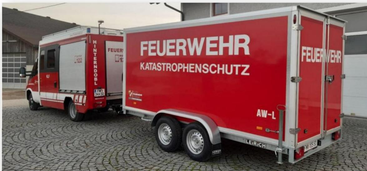
Zum Transport von bis zu 6 Rollcontainer „RC“ mit einem Einzelgewicht von bis zu 450 kg, Transport von Ladegut auf bis zu 6 Europaletten mit einem Gesamtgewicht von max. 2 to, Transport von Einsatzmitteln des KHD
