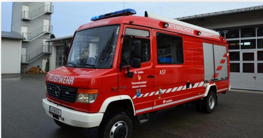
Fahrzeug zur Hilfeleistung im Einsatzbereich bei Großeinsätzen, wo eine sofortige Befüllung der Atemluftflaschen vor Ort notwendig ist, Begleitfahrzeug bei Taucheinsätzen, Hilfeleistung bei Schutzanzugeinsätzen sowie Assistenzleistung bei GSF-Einsätzen
