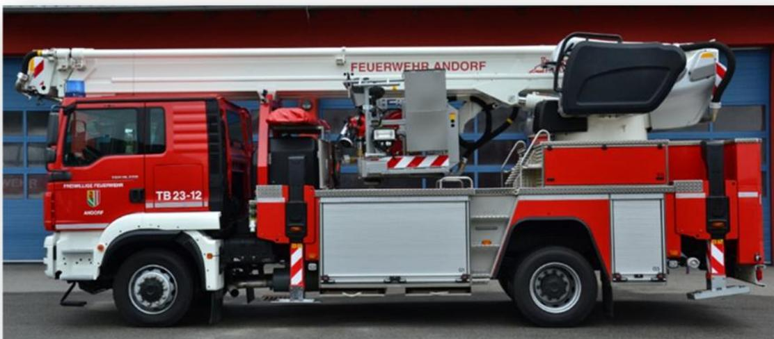
Fahrzeug zur Menschenrettung aus Höhen und Tiefen. Weiters kann das Fahrzeug zur Brandbekämpfung und für die Durchführung kleinerer technischer Hilfeleistungen eingesetzt werden.
