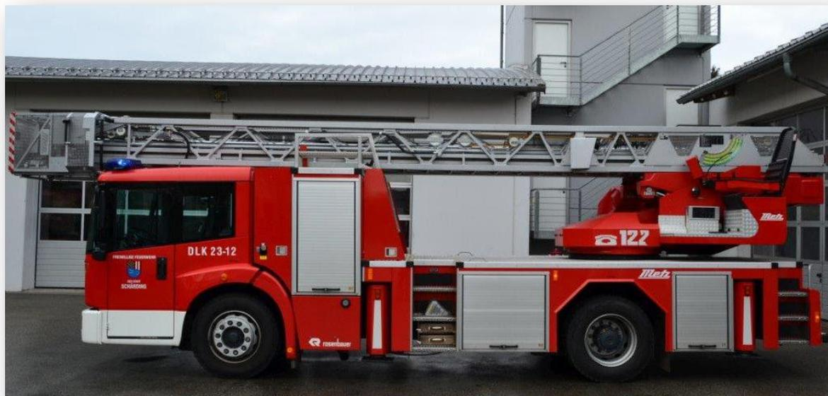
Maximale Rettungshöhe 30 Meter. Fahrzeug zur Personen oder Tierrettung aus größeren Höhen, Zur (klein) Brandbekämpfung von erhöhter Position, Technische Hilfeleistungen.
