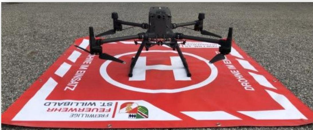
Folgende Einsatzzwecke sind für die Drohne vorgesehen: Feststellung der Einsatzlage, Darstellung der aktuellen Einsatzlage sowie Dokumentation derselben, Versorgung der Einsatzleitung mit Livebildern. Aufspüren von Wärmequellen bzw. Glutnestern bei Bränden, Suche nach Menschen und Tieren über optische oder wärmetechnische Eindrücke, usw.
