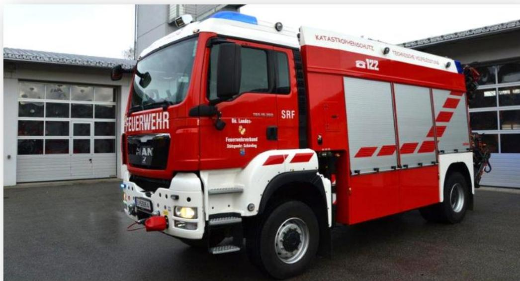
Fahrzeug mit Kran und Seilwinde sowie Gerätschaften für schwere technische Einsätze auf Straße und Schiene (VU, verschüttete Personen, Zugsunglück, LKW Unfälle, Sturmschäden, Stromversorgungen, Überschwemmungen,...)
