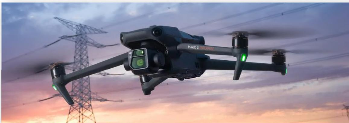
Folgende Einsatzzwecke sind für die Drohne vorgesehen: Feststellung der Einsatzlage, Darstellung der aktuellen Einsatzlage sowie Dokumentation derselben, Versorgung der Einsatzleitung mit Livebildern. Aufspüren von Wärmequellen bzw. Glutnestern bei Bränden, Suche nach Menschen und Tieren über optische oder wärmetechnische Eindrücke, usw.
