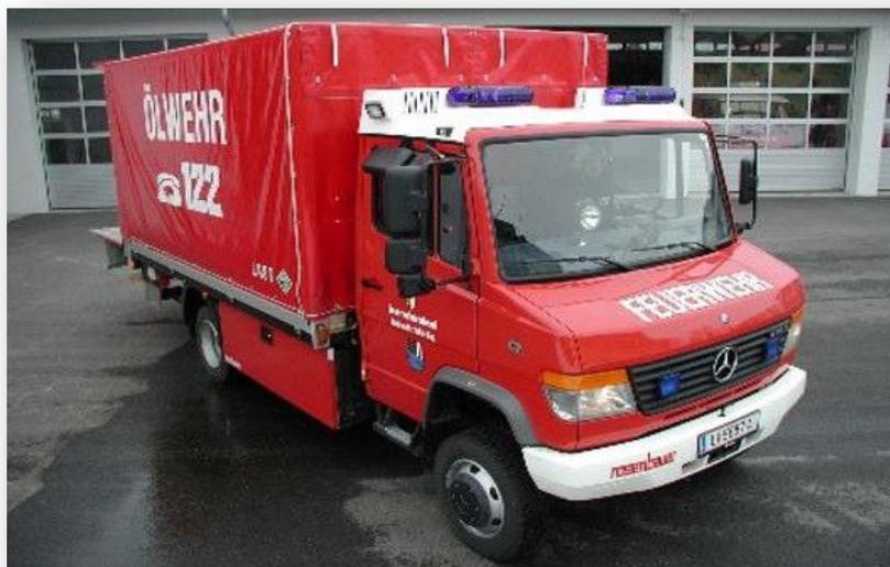
Lastfahrzeug mit Ladebordwand (1000 kg Tragkraft), ohne dauernde Beladung. Wird im Bedarfsfall je nach Anlass entweder mit Gerätschaften zur Ölschadensbekämpfung auf Gewässer, als Begleitfahrzeug des Öleinsatzfahrzeuges oder als Nachschubfahrzeug zum Transport beladen.
