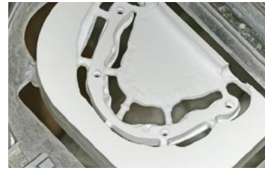
Abb. 7 und 8 Der verwendete Modellierkunststoff ist sehr präzise und auch für Einproben geeignet. Somit können Änderungen chairside vorgenommen werden. Mit einem Kopierfräsgerät wurde die Stegkonstruktion exakt in Zirkonoxid übertragen
